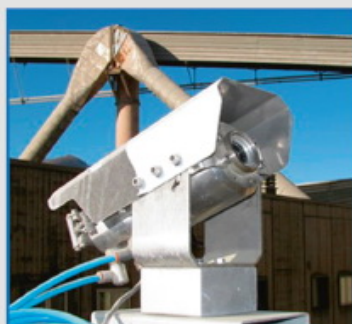
Тепловизор Optris PI в защитном кожухе
