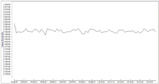
Примечание: В данном месте источник сильного возмущения тройник, прямой участок после тройника недостаточен. Качество сигнала высокое.
