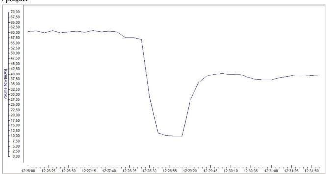
Примечание: Во время замеров оператор закрывал и затем открывал задвижку, тем самым обеспечивая переменный поток, зарегистрированный во время замеров. Прямые участки соблюдены. Характеристики качества замеров в данной точке – высокие.
