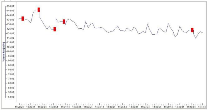
Примечание: Красным цветом обозначены места со слабым полезным сигналом. Низкий уровень сигнала в этом месте обусловлен предположительно высокой степенью коррозии (шероховатости) трубы. В данном месте источник сильного возмущения тройник, прямой участок после тройника недостаточен. Однако качество сигнала высокое.
