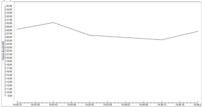
Примечание: Имевшийся в наличии комплект датчиков CDM не рекомендован для столь малых диаметров трубы. При четырёхпроходной схеме измерений уровень полезного сигнала был низкий. Однако высокое качество принятых сигналов (Q=8 согласно показаниям прибора) даёт высокую достоверность измерений. Прямые участки соблюдены.
