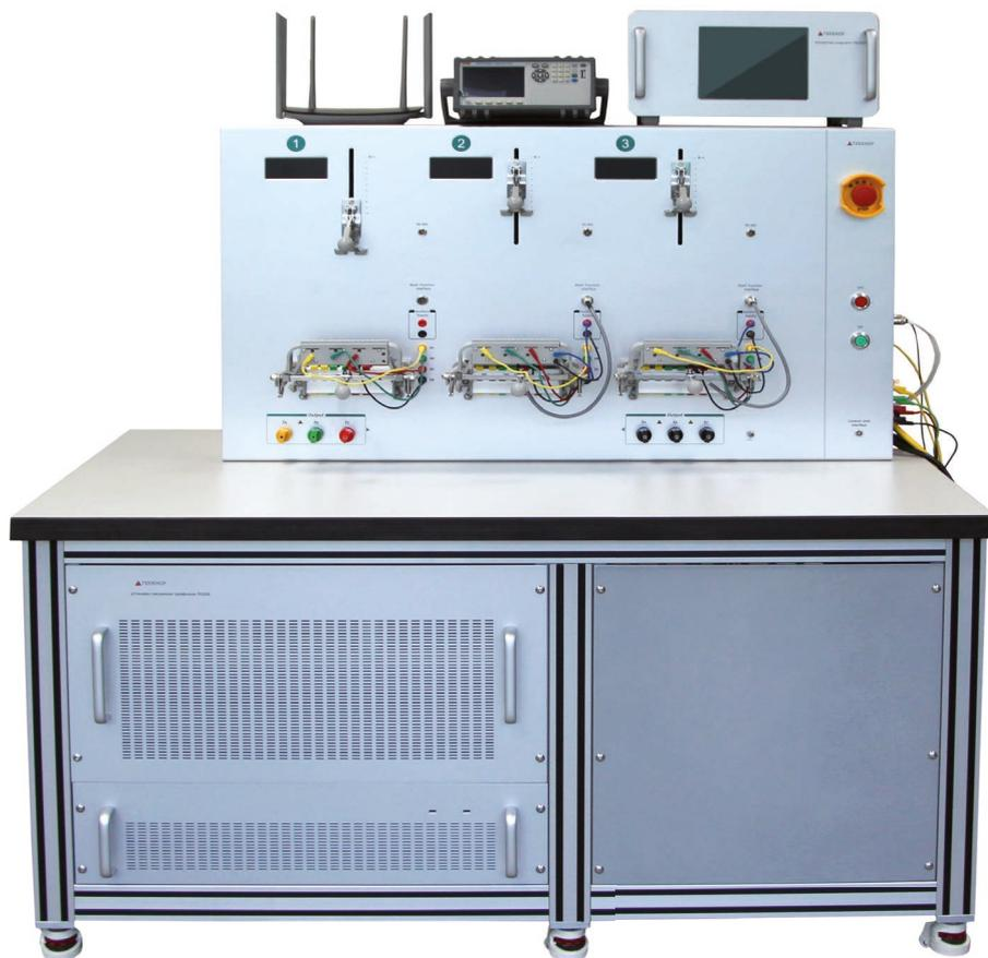
**TK2650** – это установка, предназначенная для поверки однофазных и трехфазных счетчиков активной/реактивной электроэнергии, однофазных и трехфазных ваттметров/варметров, амперметров, вольтметров, фазометров и т.д. В состав установки входит трехфазный прецизионный источник мощности, многопозиционный испытательный стенд, измерительная станция, компьютер (опция) и специальное программное обеспечение. Класс точности 0,02, 0,05.
