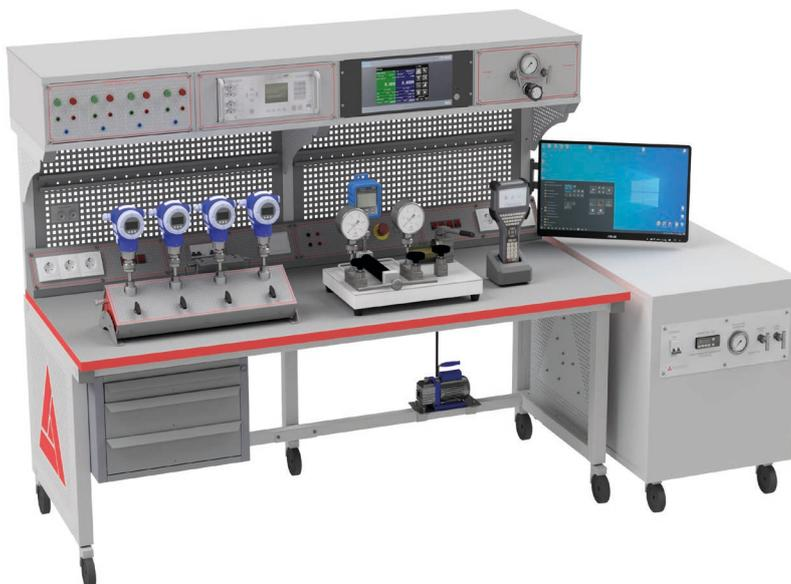
Метрологический стенд состоит из рабочего места, пневматической системы, эталонов давления, источников создания давления, вспомогательного оборудования.
